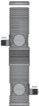
mit Kunststoff- abdeckung, überbaubar, Zu- und Ablauf DN/OD 200
