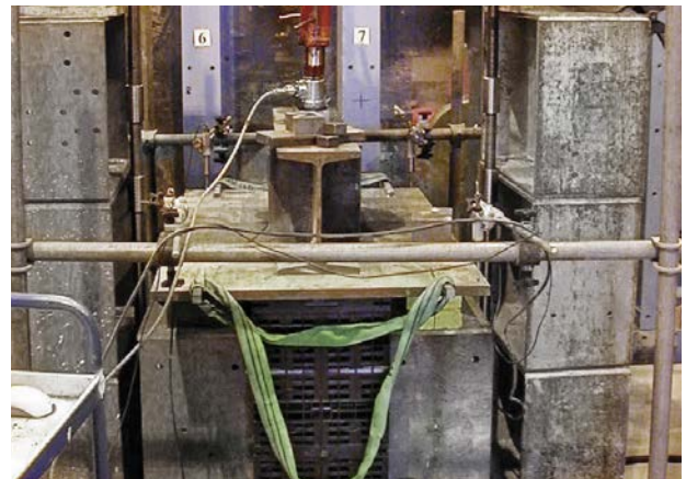
Prova di compressione orizzontale per carico distribuito
