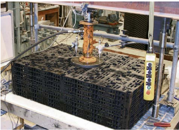
Prova di compressione verticale per carico puntuale
