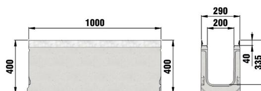
**SERVICE CHANNEL FASERFIX SUPER 300** in calcestruzzo fibrorinforzato con telaio da 40 mm, Classe E 600
