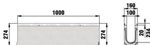
**SERVICE CHANNEL FASERFIX KS 150** in calcestruzzo fibrorinforzato con telaio da 20 mm, Classe E 600
