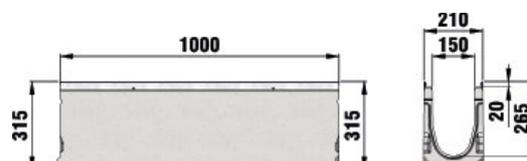
**SERVICE CHANNEL FASERFIX KS 200** in calcestruzzo fibrorinforzato con telaio da 20 mm, Classe C 250 / E 600
