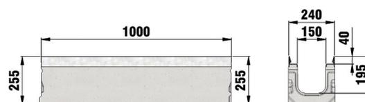
**SERVICE CHANNEL FASERFIX SUPER 200** in calcestruzzo fibrorinforzato con telaio da 40 mm, Classe E 600
