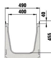
**SERVICE CHANNEL FASERFIX SUPER 500** in calcestruzzo fibrorinforzato con telaio da 40 mm, Classe E 600
