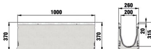
**SERVICE CHANNEL FASERFIX KS 300** in calcestruzzo fibrorinforzato con telaio da 20 mm, Classe C 250
