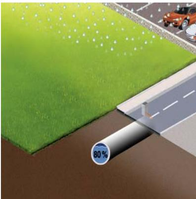
Figura 1: situazione originale del terreno. L'acqua piovana può infiltrarsi nel terreno. Utilizzazione del sistema fognario 80%.
