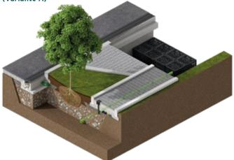
Dieses System sichert eine nachhaltige Bewässerung von Baumgruben. Es besteht aus der Filtersubstratrinne **DRAINFIX CLEAN**, die Regenwasser sammelt, filtert und Teile des gereinigten Wassers zum bepflanzbaren Retentionsraum ableitet. Der andere Teil wird in die Versickerungsrigole **DRAINFIX BLOC** geleitet und kann dort versickern. Dadurch wird kostbares Trinkwasser gespart. Das Konzept ist ideal für Alleen und enge Bereiche.
