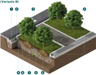
Diese Variante erlaubt die direkte Bewässerung von mehreren Grünflächen mit gereinigtem Regenwasser aus der Filtersubstratrinne über ein System. Die Baumgrube ist überbaubar und kann als Parkplatz oder Fußgängerweg genutzt werden. Das Konzept eignet sich für Grünflächen mit mehreren Bäumen.
