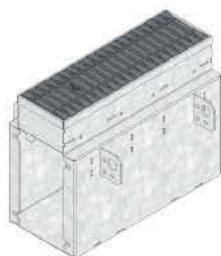
Челна плочка с комплект винтове, поцинкована, за улей Тип 230
