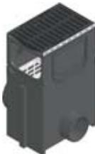
Avaloir avec panier galva, raccordement latéral DN 200, et grille fonte à fentes 2x128x18, classe D 400, montée et clavetée
