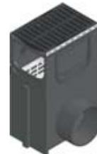
Avaloir avec panier galva, raccordement latéral DN 315, et grille fonte à fentes 2x128x18, classe D 400, montée et clavetée
