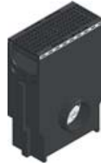
Avaloir avec panier galva et GUGI caillebotis fonte, mailles 15x22, noire, classe C 250, montée et clavetée
