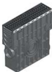
Avaloir avec panier PVC et GUGI caillebotis fonte, mailles 16x22, noire, classe C 250, montée et clavetée
