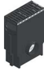
Avaloir avec panier galva et grille fonte à fentes 2x85x19, noire, classe C 250, montée et clavetée
