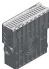
Avaloir avec panier PVC et grille passerelle, fentes 75x9, agrée passage VL, montée et clavetée
