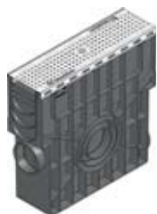
Avaloir avec panier PVC et grille perforée, Ø 6 mm, classe A 15, montée et clavetée
