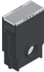
Avaloir avec panier galva et grille caillebotis, mailles 30x10, classe B 125, montée et clavetée
