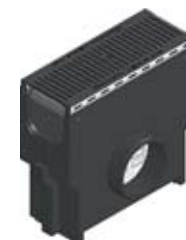
Avaloir avec panier galva et grille en fonte, fentes 131x6, noire, classe C 250, montée et clavetée
