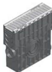
Avaloir avec panier PVC et grille caillebotis, mailles 30x10, agrée passage VL, montée et clavetée
