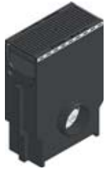
Avaloir avec panier galva et grille fonte à fentes 181x6, noire, classe C 250, montée et clavetée
