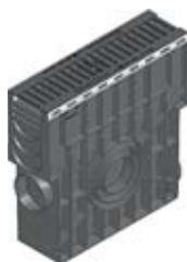
Avaloir avec panier PVC et grille fonte, à fentes 81x14, noire, classe C 250, montée et clavetée
