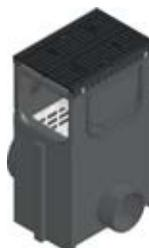
Avaloir en PP avec panier galva et grille fonte G-TEC, à fentes 2x14x9, KTL, noire, montée et clavetée, avec raccordement latéral DN 200
