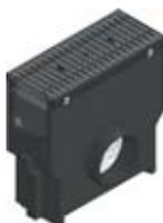
Avaloir en PP avec panier galva et grille FIBRETEC, à fentes 9 mm, en PA, noire, classe C 250, montée et clavetée
