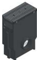
Avaloir en PP avec panier PVC et grille FIBRETEC, à fentes 9 mm, en PA, noire, classe B 125, montée et clavetée
