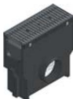
Avaloir en PP avec panier galva et grille FIBRETEC, à fentes 9 mm, en PA, noire, classe B 125, montée et clavetée
