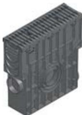
Avaloir en PP avec panier PVC et grille FIBRETEC, à fentes 9 mm, en PA, noire, classe C 250, montée et clavetée
