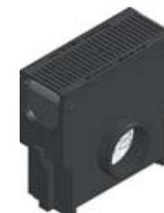
Avaloir avec panier galva et grille fonte, à fentes 131x6, noire, classe C 250, montée et clavetée
